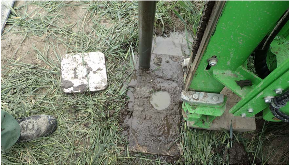
Figur 6. Grundvandet stiger op til jordoverfladen i boring 197.673.
